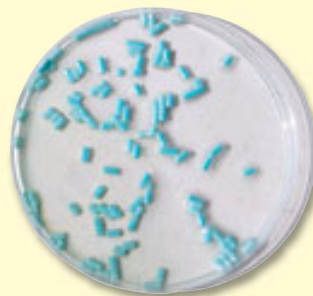
Ferramol Etanasyötti 24 tunnin kosteuden jälkeen
